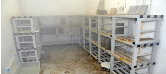
Figura 16. Cámara húmeda de curado de las probetas.
