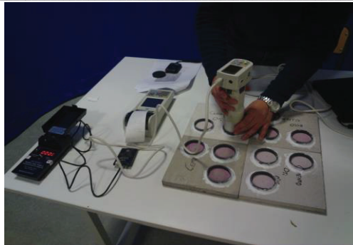
Figura 5. Medición de la fotodegradación utilizando un colorímetro.
