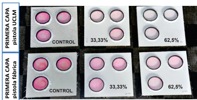
Figura 6. Fotografía comparativa de muestra de la degradación de color entre pistolas para diferentes porcentajes de adición de \text{TiO}_2 .
