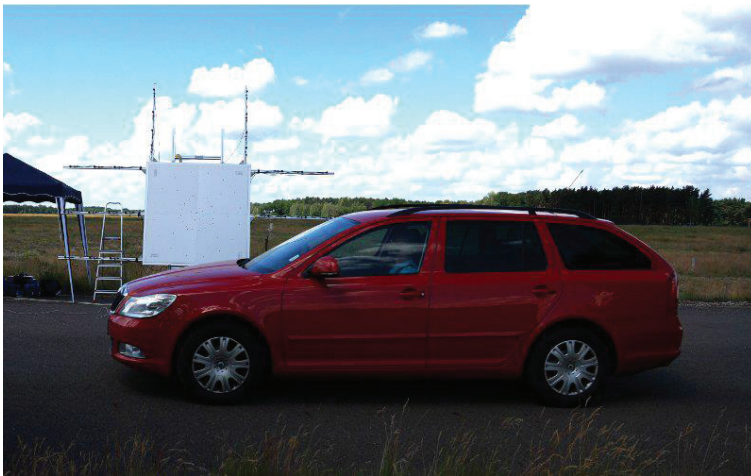
Figura 7. Realización de las medidas de pass-by.
