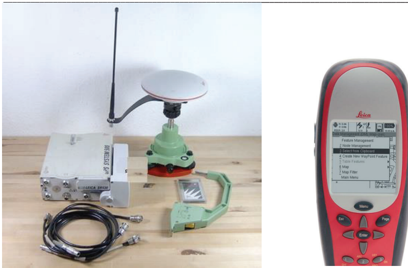
Figura 2. Instrumentación utilizada en las medidas. Antena geodésica AT503, ERP System 1200 y GPS monofrecuencia.
