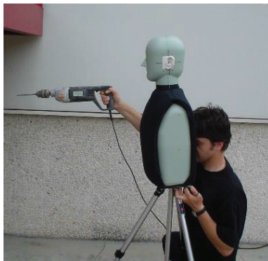
Figura 3. Realización de medidas con un HATS.
