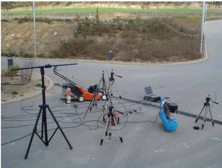
Figura 6. Realización de medidas para evaluar el preprocesado Cepstrum.
