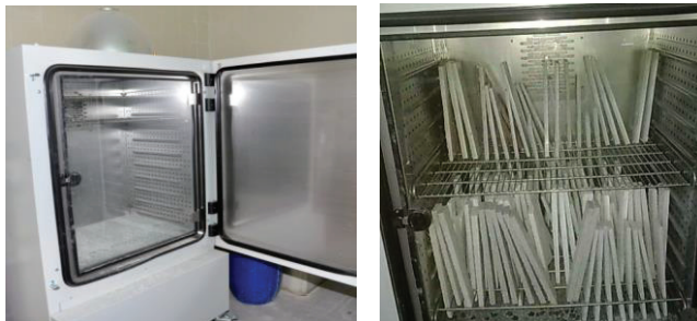
Figura 17. Cámara climática para realización de los ciclos de durabilidad.
