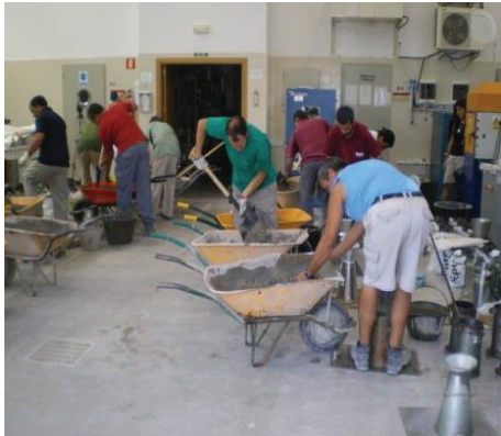
Figura 2. Toma de muestras de hormigón fresco de la campaña de ensayos interlaboratorios.
