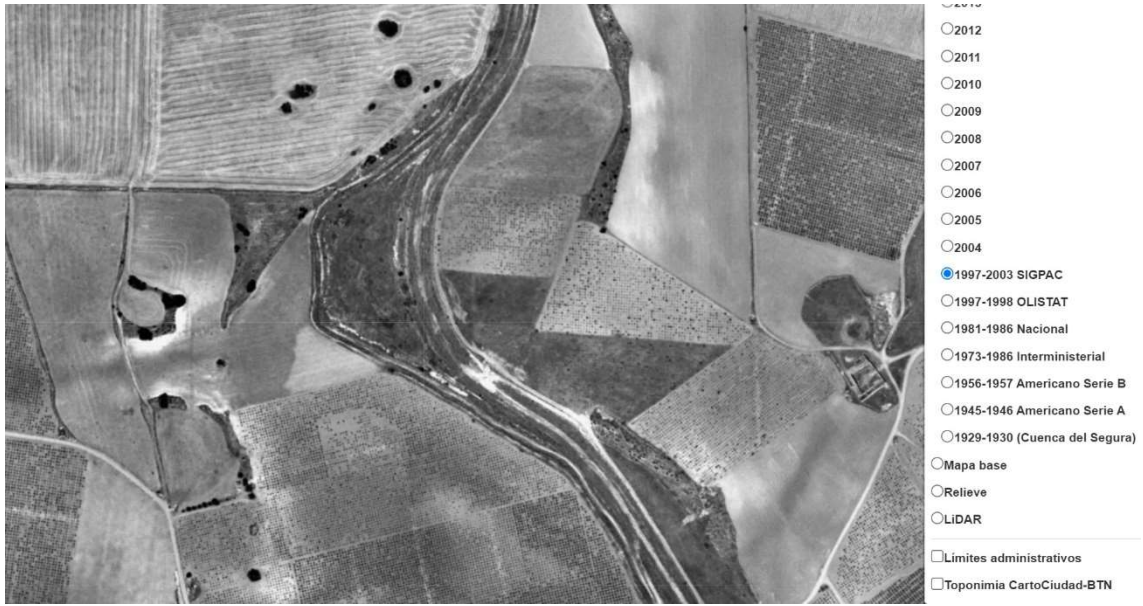
Figura 47: Ortofotografía del SIGPAC 1997-2003. Junto al tramo conservado del canal, se aprecia la existencia ex novo de un cauce paralelo. Se trata del ya mencionado cauce de avenamiento de las aguas de la presa de Peñarroya, construido, obviamente, tras la erección de esta última.
