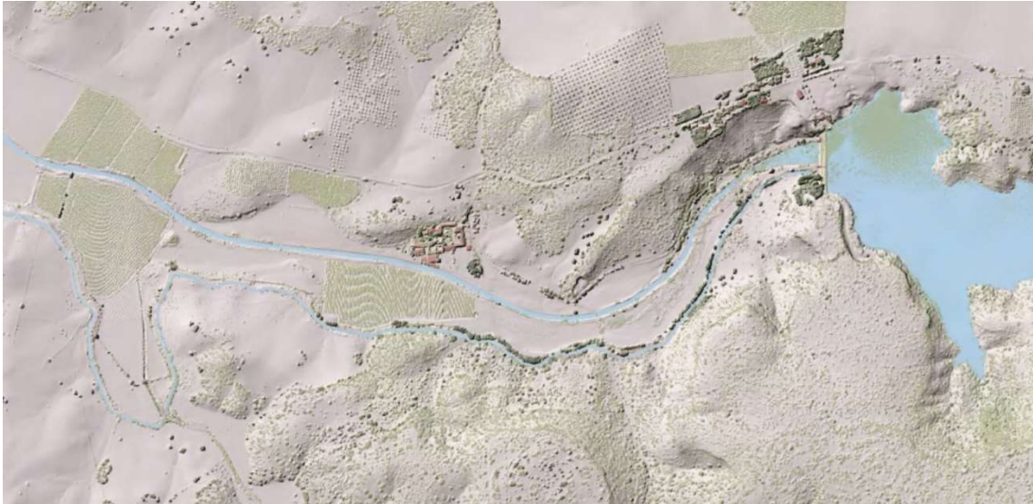
Figura 16: Imagen LiDAR, que representa la presa, el canal del siglo XX y el talweg en funciones de canal de avenamiento del embalse.
