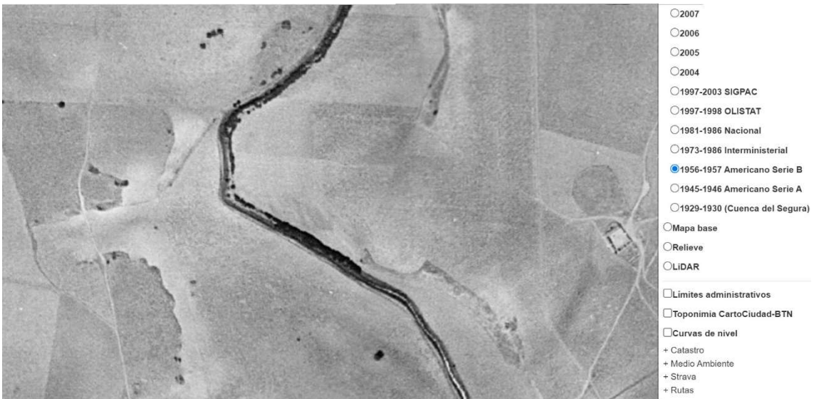
Figura 46: Ortophotografía del Vuelo Americano 1957-1959. Serie B, correspondiente al tramo entre molino del Cuervo y casa del Minguillo. El único cauce que se aprecia es el del canal del Gran Prior. No existía el canal de avenamiento: el río Malecón se extingue antes del molino del Cuervo y el canal de avenamiento del embalse de Peñarroya, ahora llamado “río Guadiana Alto”, no se había construido.
