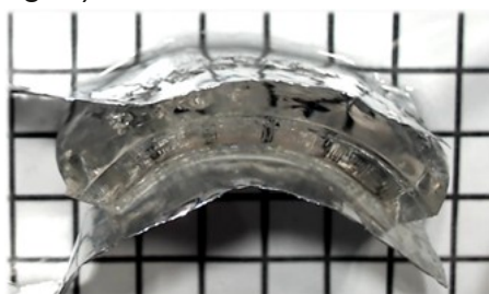
Figura 3: Hidrogel curvado ante estímulo eléctrico con electrodos dañados por la corriente.
