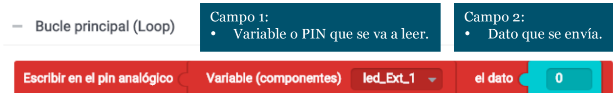
Figura 1.2.2-3. Programa en BitBloq para cambiar la intensidad de un LED.
