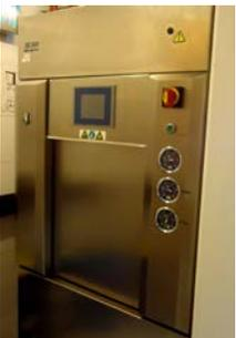
Los autoclaves son recipientes metálicos, herméticos y de paredes gruesas. Permiten realizar tratamientos de esterilización con calor húmedo a presión. Un autoclave inactiva virus y bacterias. Se han descrito algunos agentes biológicos, como los priones, que pueden sobrevivir a las temperaturas del autoclave. El correcto funcionamiento del autoclave ha de ser verificado y registrado mediante controles químicos, físicos o biológicos.
